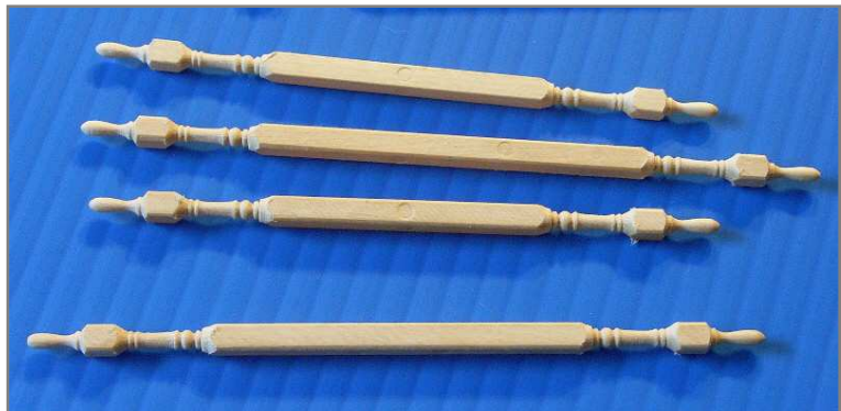
Fertige Speichen, noch am Stück
